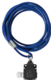
Buton cu tracțiune cu cablu Este posibilă montarea în poziție orizontală sau verticală, carcasa este din aluminiu turnat sub presiune, IP 65, lungimea cablului 4 m
