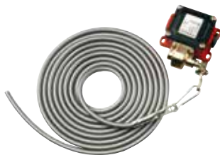
Înterupător cu tracțiune cu cablu de tracțiune din material plastic Este posibilă montarea în poziție orizontală sau verticală, carcasa este din aluminiu turnat sub presiune, IP 65, lungimea cablului 4 m
