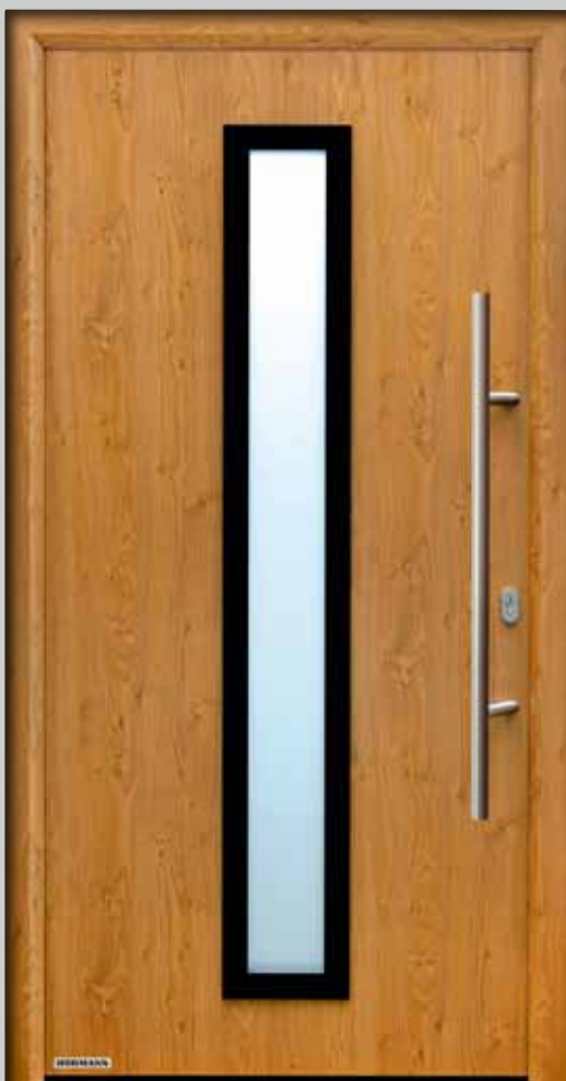
Model 600 ■ NOU începând cu vara lui 2017 Figură: Decograin Winchester Oak Mâner de oțel inoxidabil HB 38-2 pe un blat de oțel, cu vitrare aplicată: geam izolator triplu, sticlă laminată de siguranță la exterior, la mijloc Float sablat, în interior ESG clar, coeficient U_D cu valoare aprox. 1,0 \text{ W}/(\text{m}^2 \cdot \text{K})^* Element lateral / oberliht Geam izolator triplu, sticlă laminată la exterior, la mijloc Float, în interior ESG
